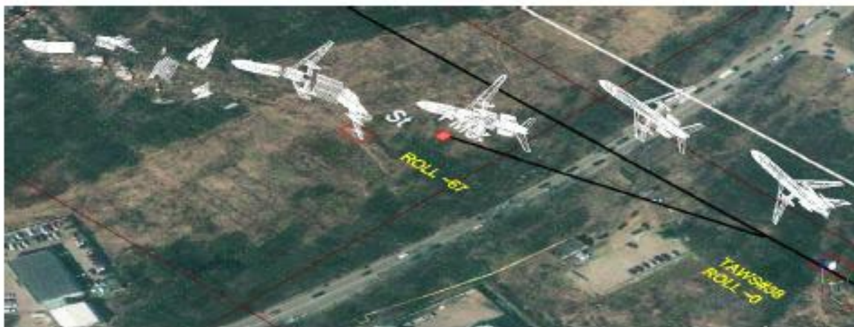
Rys. 21c. Próba rekonstrukcji rozpadu płatowca.
