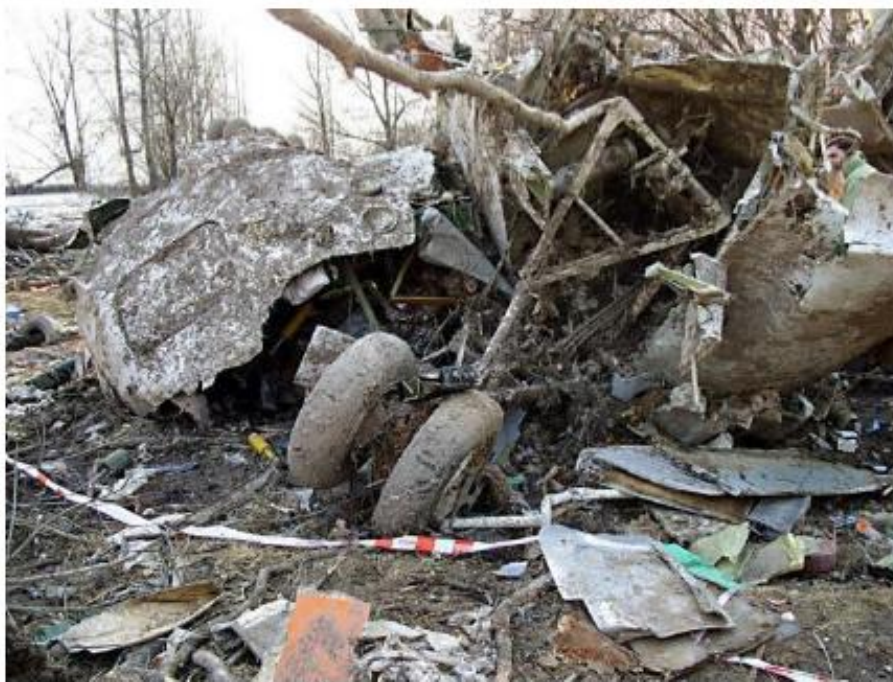
Rys. 5. Resztki salonki w prawidłowej pozycji na ziemi. Także resztki podwozia przedniego, oderwane od podstawy, pokazane z tyłu.
