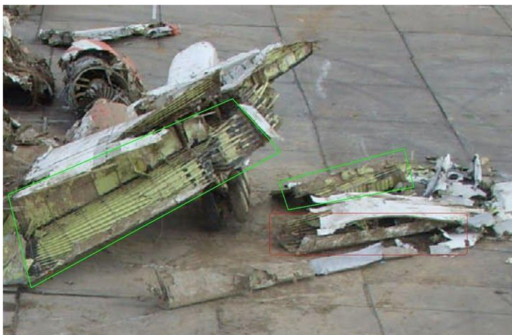
Na płycie lotniska widoczny centropłat lewy z wyrwaną częścią poszycia górnego i dolnego po dźwigarze nr 1. Sam dźwigar znajduje się po prawej stronie na nawierzchni betonowej (w zielonej ramce).
